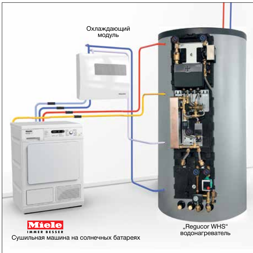
Подключение сушильной машины Miele на солнечных батареях к „Regucor WHS“ Oventrop
